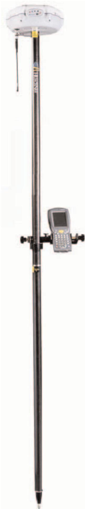
Ricevitore L1 configurabile in funzione base o rover, rilevamento in modalità RTD ( Real Time Distance ), Fast-Kinematic oppure RTK ( Real Time Kinematic ) senza bisogno di riconfigurare l'hardware strumento. Collegamento base-rover tramite GPRS oppure tramite Radio modem. Completamente configurabile per l'accesso alle reti VRS ( Virtual Reference Station ), MRS ( Multi Reference Stations ), RTK ( Real Time Kinematic ).
