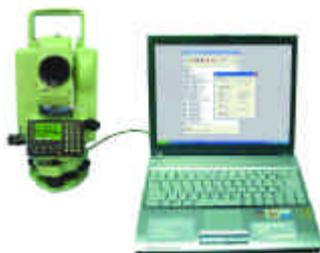
Il software Comm600 per il carico-scarico dati tra strumento-computer tramite cavo di interfaccia RS232 è utilizzabile con Autocad e con Pregeo 8.00
