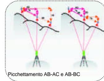
Picchettamento in tempo reale senza bisogno di inserire i punti in memoria e presentazione sul display di distanza inclinata, ridotta sull'orizzontale, dislivello. Due metodi di picchettamento: sequenziale AB-BC-CD... progressivo AB-AC-AD...
