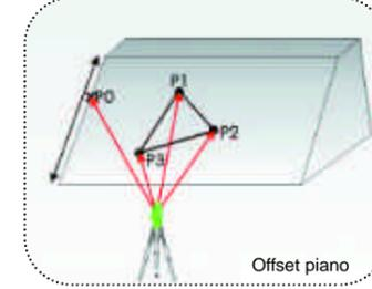
Calcolo punto inaccessibile tramite lettura al prisma posto su di un piano precedentemente definito tramite la lettura di tre punti posti sul piano di rilievo reale.
