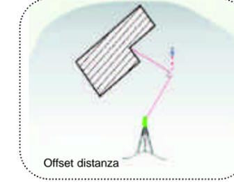
Calcolo punto inaccessibile tramite lettura al prisma di un punto inaccessibile e successivo del quale è nota la distanza orizzontale rispetto al punto inaccessibile da rilevare. (Solo per serie 680 e 700)
