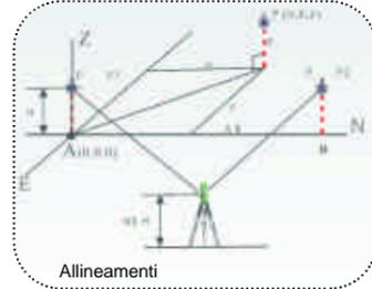
Il primo punto battuto è l'origine degli assi cartesiani. Il secondo punto definisce l'orientamento della direttrice nord. Vengono calcolate le coordinate del punto di stazione. Tutti i punti battuti in seguito vengono riferiti a questo sistema di riferimento.
