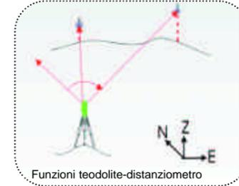
Sono presenti sullo strumento tutte le funzioni tipiche di uno strumento topografico optoelettronico quali la possibilità di misurazione delle distanze inclinate, ridotte sull'orizzontale e dislivello. Visualizzazione azimuth, zenit, azzeramento azimuth, indice zenit in % o centesimale, zero zenit sull'orizzontale o sullo zenit, misure cartesiane, ...
