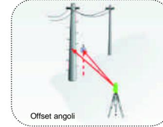
Calcolo punto inaccessibile tramite lettura al prisma posto alla stessa distanza del punto di rilievo che si deve rilevare. Visualizzazione in tempo reale della distanza di lettura al prisma e dell'angolo azimutale di offset.
