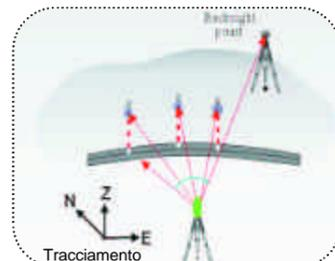
Tracciamento con trasferimento dati da PC a strumento ed inserimento dalla tastiera dei punti da tracciare. Calcolo EQM in tempo reale. Calcolo fattore di riduzione in coordinate Gauss-Boaga direttamente in campagna.
