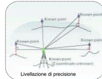
Calcolo della quota di stazione riferita a punti di coordinate note. Dati gestibili dalla memoria interna oppure direttamente in campagna mediante inserimento diretto nello strumento dalla tastiera. Visualizzazione in tempo reale dei risultati ottenuti.
