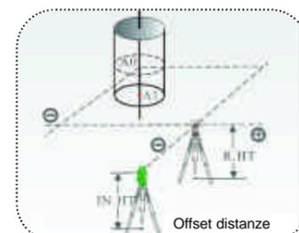
Calcolo punto inaccessibile tramite lettura al prisma posto ad una distanza dall'asse di collimazione nota e/o perpendicolare all'asse di collimazione nota.
