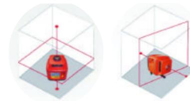
JP300 è un livello laser autolivellante automatico con una portata utile di 150m di raggio che permette di effettuare livellazioni orizzontali, tracciamenti su piano verticale e squadrature.
