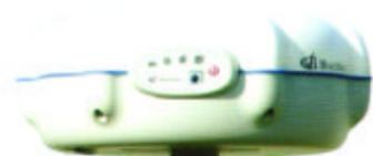
Ricevitore L1+L2+Glonass ( opzionale ) configurabile in funzione base o rover con rilevamento in modalità RTD ( Real Time Distance ), Fast-Kinematic oppure RTK ( Real Time Kinematic ) senza bisogno di riconfigurare l'hardware strumento. Il collegamento base-rover è possibile sia tramite GPRS che con Radio modem. Perfettamente adatto all'utilizzo con reti VRS ( Virtual Reference Station ), MRS ( Multi Reference Stations ), RTK ( Real Time Kinematic ).
