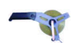
Rotella metrica con telaio a crociera in acciaio, Lunghezza 50 m, Larghezza 13 mm, con impugnatura ergonomica in abs e custodia. Classe di precisione II
