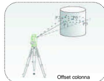
Calcolo punto inaccessibile centro colonna tramite lettura del punto P1 sull'asse centro pilastro P1-P0 e dell'estremo sinistro P2 ed estremo destro P3. Visualizzazione in tempo reale delle coordinate offset.
