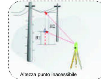
Calcolo altezza punto inaccessibile tramite lettura al prisma e tramite letture senza prisma per la serie OTS. Calcolo dell'altezza prisma, calcolo altezza punto inaccessibile senza bisogno di battere il punto. Visualizzazione in tempo reale dell'altezza calcolata.
