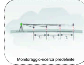
Impostazione, monitoraggio e ricerca distanza predefinita su distanze dirette, ridotte sull'orizzontale e distanza verticale con possibilità d'inserimento di tutti i valori simultaneamente e con risposta in tempo reale. Distanziometro con funzione tracciamento ed aggiornamento dati ogni 1".
