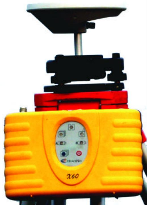
Sistema GPS L1+L2+Glonass ( opzionale ) in configurazione separata Antenna + Gruppo Centrale con radio modem integrato + Controller.
