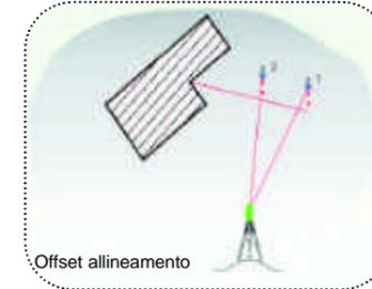
Calcolo punto inaccessibile tramite lettura al prisma di due punti noti e somma della misura lineare del punto inaccessibile sul prolungamento allineamento. (Solo per serie 680 e 700)
