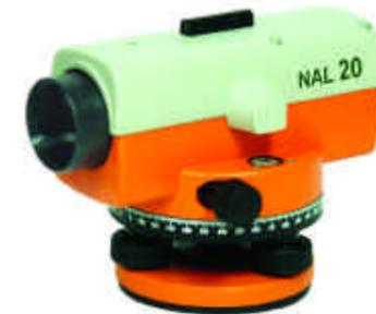
La serie NAL è costruita interamente in metallo con grado di protezione IP67. Il compensatore automatico a smorzamento magnetico consente misurazioni veloci e precise e garantisce la bontà delle misure anche in condizioni d'uso difficili. Il blocco del compensatore automatico quando lo strumento viene riposto nella custodia in pvc imbottita antiurto salvaguarda la taratura dello strumento ed il compensatore stesso durante il trasporto.
