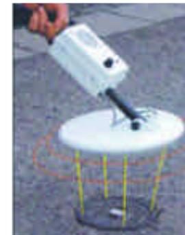
Per localizzare chiusini nascosti, coperchi d'idrante e qualsiasi altra parte di metallo in posizione orizzontale con un diametro minimo di 10cm.
