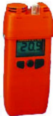
Il Crowcon Gasman II è un rilevatore di gas ad uso individuale in grado di monitorare costantemente il livello di ossigeno o la presenza di un singolo gas tossico o infiammabile. E' stato progettato per essere indossato da persone che lavorano in ambienti pericolosi come ad esempio gli spazi ristretti ed emette un intenso allarme sonoro e visivo quando vengono superate le concentrazioni di gas preimpostate.
