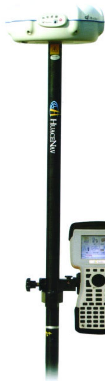
Ricevitore L1+L2+Glonass ( opzionale ) configurabile in funzione base o rover con rilevamento in modalità RTD ( Real Time Distance ), Fast-Kinematic oppure RTK ( Real Time Kinematic ) senza bisogno di riconfigurare l'hardware strumento. Il collegamento base-rover è possibile sia tramite GPRS che con Radio modem. Perfettamente adatto all'utilizzo con reti VRS ( Virtual Reference Station ), MRS ( Multi Reference Stations ), RTK ( Real Time Kinematic ).
