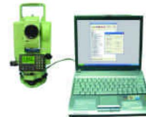
Il software Comm600 per il carico-scarico dati tra strumento-computer tramite cavo di interfaccia RS232 è utilizzabile con Autocad e con Pregeo 8.00
