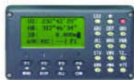
Il doppio pannello comandi fronte-retro con ampio display a 4 linee ed ampi caratteri, retroilluminato ed illuminazione del reticolo. Doppia tastiera alfanumerica a 23 tasti con interfaccia one-touch.
